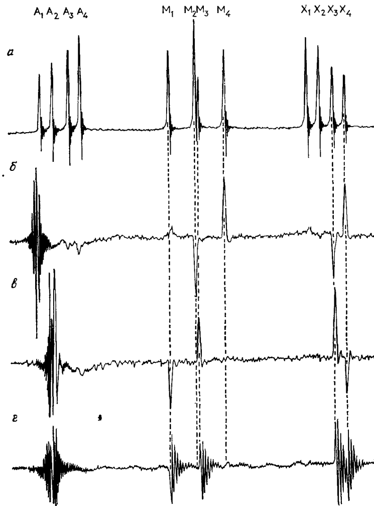
Рис. IX.15. Спектр ЯМР ( a ), ИНДОФ-спектры ( b , в ) и осцилляции Торри ( z ) в системе AMX 2,3-дибромпропионовой кислоты (188).
